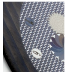
30 ▶ Structuration de surface par laser. © Laser Cheval.
