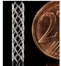
29 ▶ Les lasers permettent l'usinage de précision, comme pour ces endoprothèses destinées à consolider des artères endommagées. La pièce donne l'échelle. © Amplitude Systems
